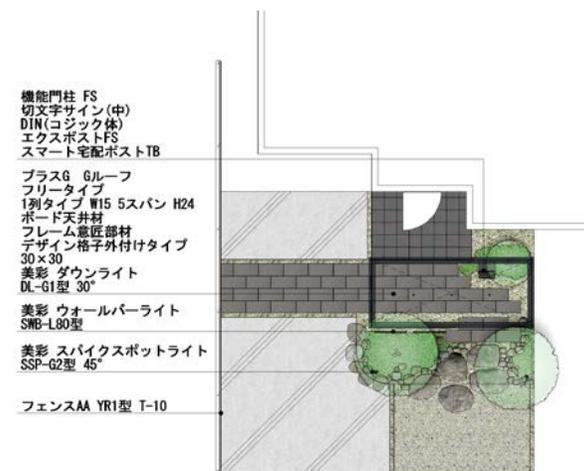
フレーム前面に取り付け可能な外付けタイプのデザイン格子は、フレーム意匠部材で格子の天端を重ねることで、端正で美しい仕上がりになります。デザイン格子のスクリーンの前は植栽で爽やかに飾り、上質な和モダンのファサード空間を演出します。
